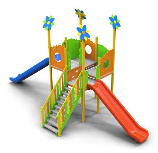
Gioco per parco realizzato con travi portanti in alluminio sezione cm 9 x 9, pedane in alluminio, pannelli laterali in polietilene colorato di adeguato spessore, viteria zincata. Composto da:
