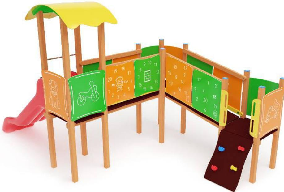
Gioco per parco realizzato in legno di LARICE montano a crescita lenta lamellare sezione cm 7 x 7, pedane di calpestio in multistrato antisdrucchiolo, pannelli laterali in polietilene colorato di adeguato spessore, tetto in polietilene, viteria zincata, staffe di fissaggio al suolo in acciaio zincato a caldo.
