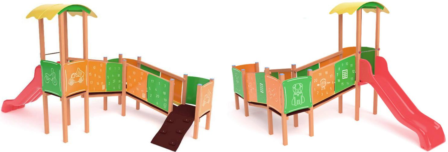
Gioco per parco realizzato in legno di LARICE montano a crescita lenta lamellare sezione cm 7 x 7, pedane di calpestio in multistrato antisdrucchiolo, pannelli laterali in polietilene colorato di adeguato spessore, tetto in polietilene, viteria zincata, staffe di fissaggio al suolo in acciaio zincato a caldo.
