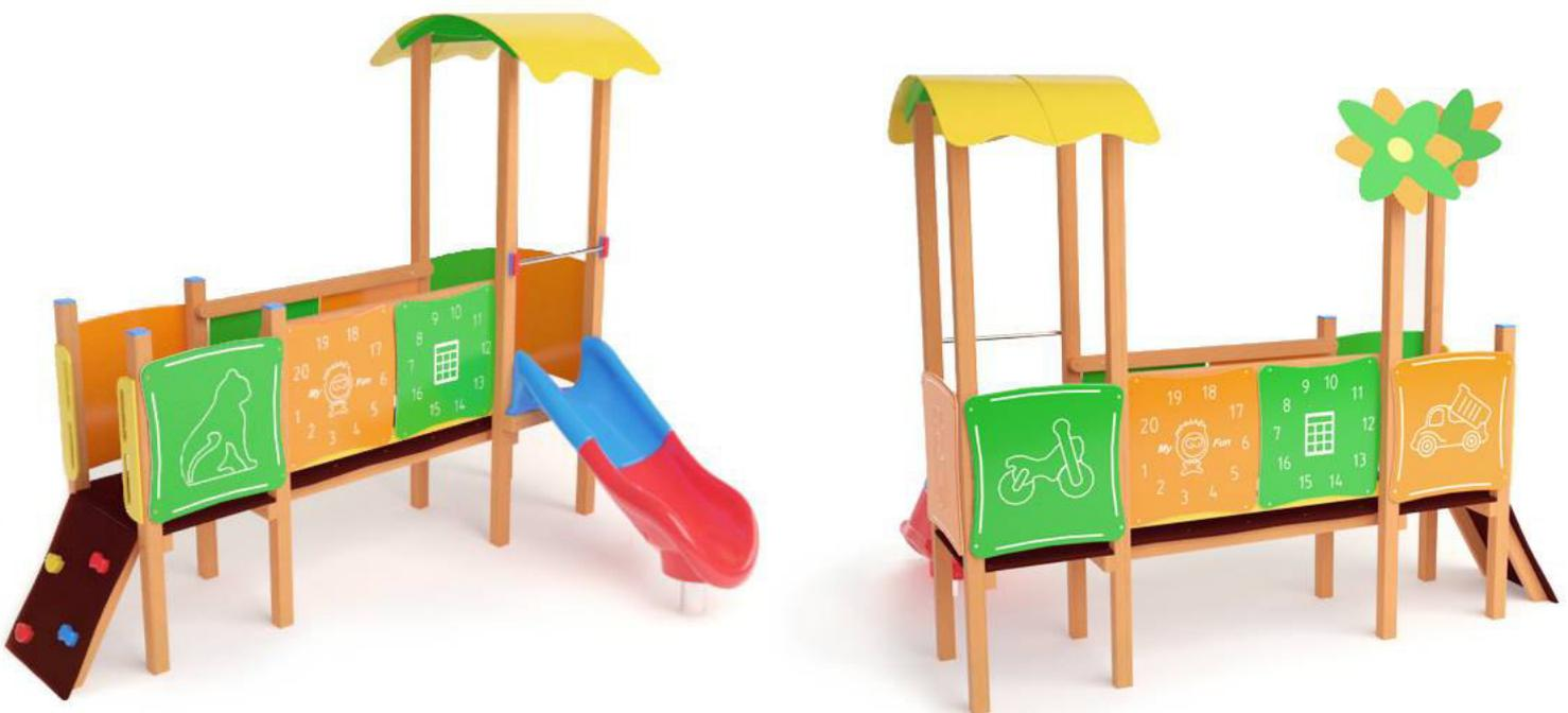
Gioco per parco realizzato in legno di LARICE montano a crescita lenta lamellare sezione cm 7 x 7, pedane di calpestio in multistrato antisdrucchiolo, pannelli laterali in polietilene colorato di adeguato spessore, tetto in polietilene, viteria zincata, staffe di fissaggio al suolo in acciaio zincato a caldo.
