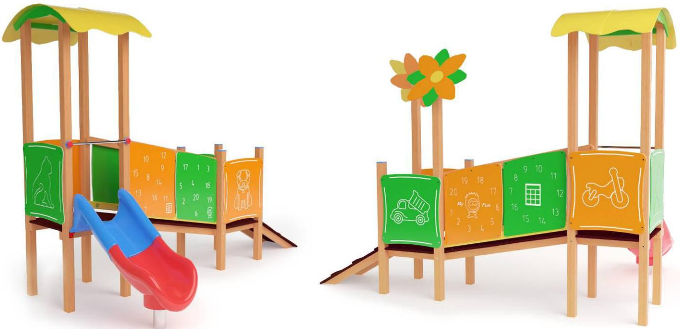
Gioco per parco realizzato in legno di LARICE montano a crescita lenta lamellare sezione cm 7 x 7, pedane di calpestio in multistrato antisdrucchiolo, pannelli laterali in polietilene colorato di adeguato spessore, tetto in polietilene, viteria zincata, staffe di fissaggio al suolo in acciaio zincato a caldo.
