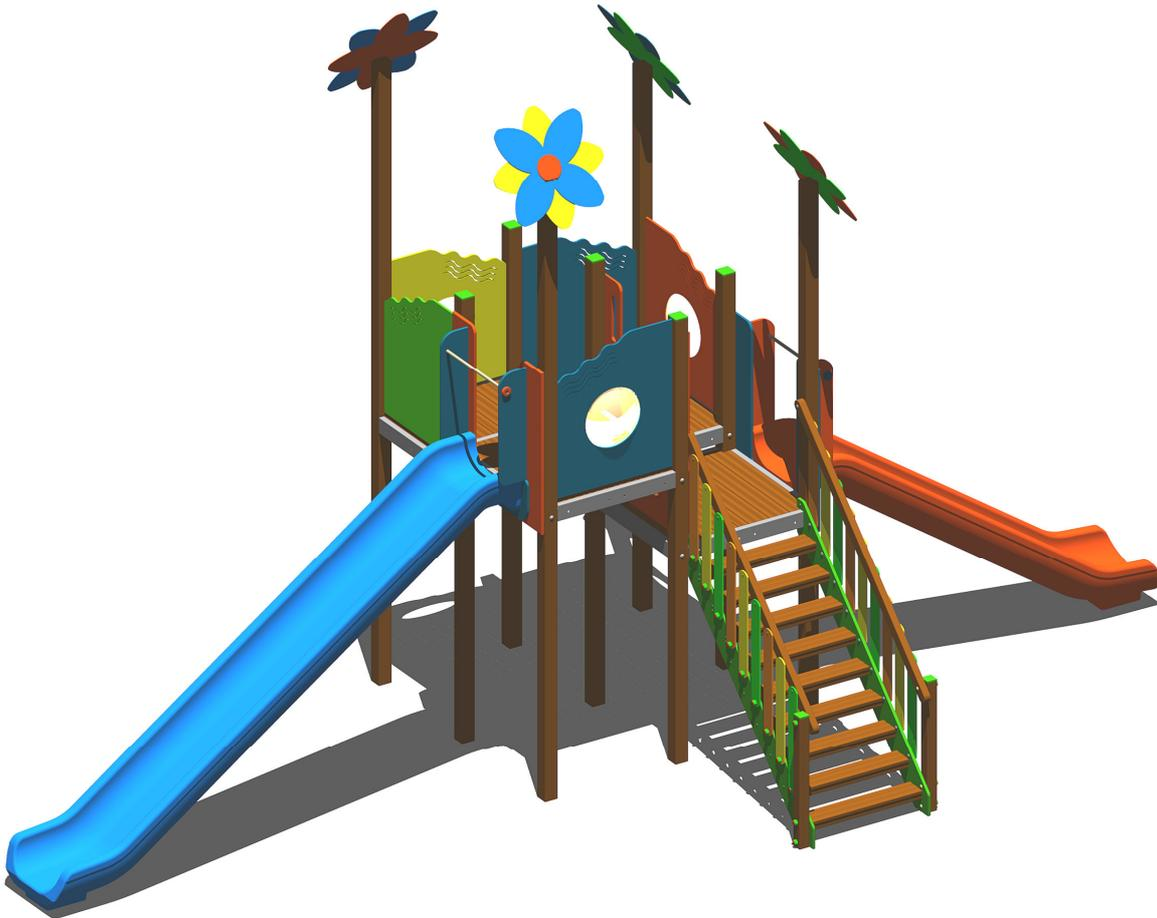
Gioco per parco realizzato in legno di LARICE montano a crescita lenta lamellare sezione cm 9 x 9, pedane di calpestio in tavole di larice con profilo antisdrucchiolo, profili di contenimento pedane in acciaio zincato e verniciato a polveri, pannelli laterali in polietilene colorato di adeguato spessore, viteria.
