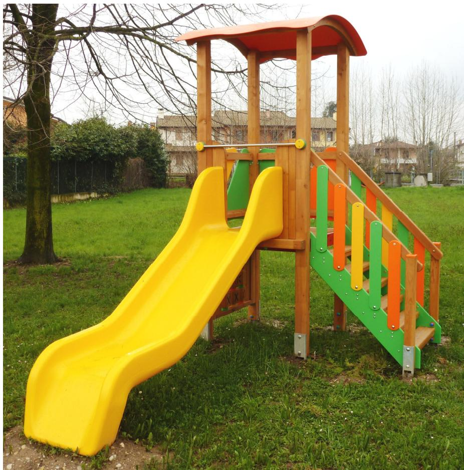
Gioco per parco realizzato in legno di LARICE montano a crescita lenta lamellare sezione cm 9 x 9, pedane di calpestio in tavole di larice con profilo antisdrucchiolo, profili di contenimento pedana in acciaio zincato e verniciato a polveri, pannelli laterali e tetto in polietilene colorato di adeguato spessore viteria zincata, staffe di fissaggio al suolo zincate.
