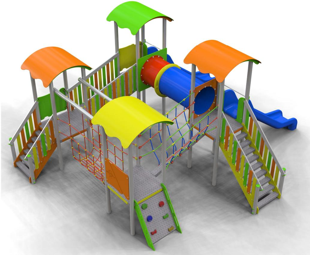
Gioco per parco realizzato con travi portanti in alluminio sezione cm 9 x 9, pedane in alluminio, pannelli laterali e tetti realizzati in polietilene colorato di adeguato spessore, viteria zincata, staffe di fissaggio al suolo in acciaio zincato a caldo.
