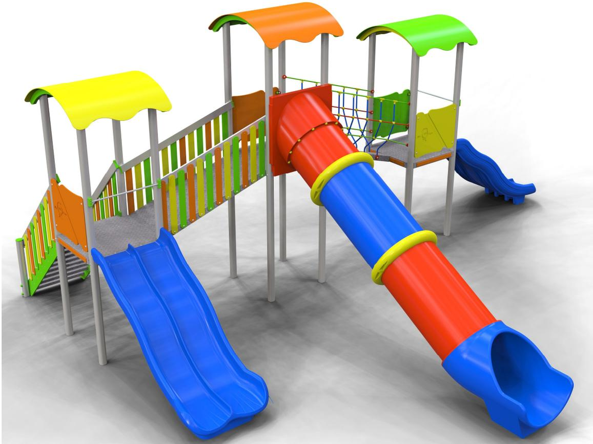
Gioco per parco realizzato con travi portanti in alluminio sezione cm 9 x 9, pedane in alluminio, pannelli laterali e tetti realizzati in polietilene colorato di adeguato spessore, viteria zincata, staffe di fissaggio al suolo in acciaio zincato a caldo.
