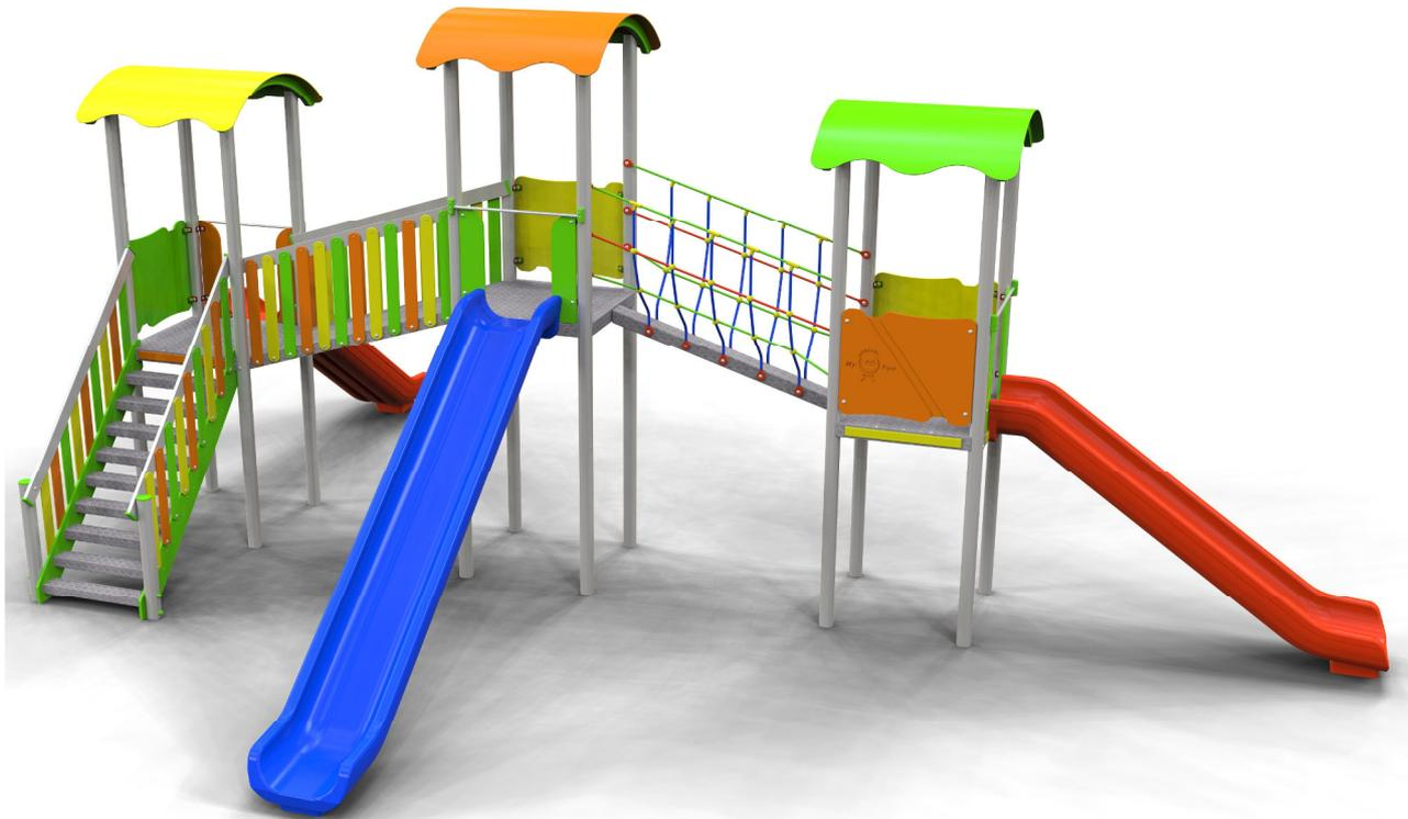
Gioco per parco realizzato con travi portanti in alluminio sezione cm 9 x 9, pedane in alluminio, pannelli laterali e tetti realizzati in polietilene colorato di adeguato spessore, viteria zincata, staffe di fissaggio al suolo in acciaio zincato a caldo.
