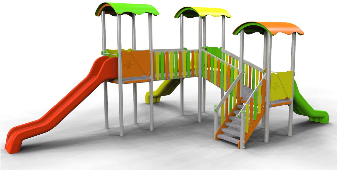
Gioco per parco realizzato con travi portanti in alluminio sezione cm 9 x 9, pedane di calpestio in alluminio, pannelli laterali in polietilene colorato di adeguato spessore, tetto realizzato in polietilene colorato di adeguato spessore su telaio curvo in polietilene, viteria zincata, staffe di fissaggio al suolo in acciaio zincato a caldo.
