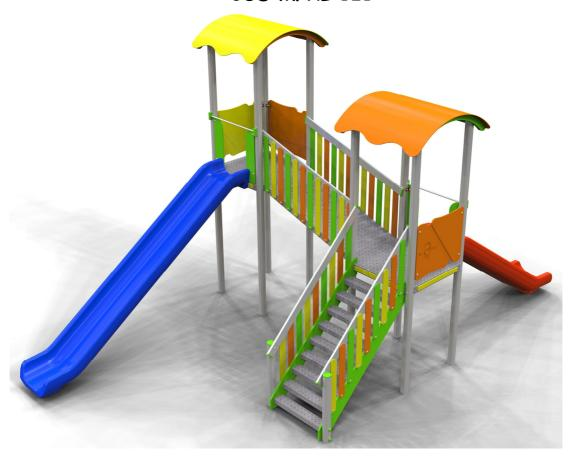
Gioco per parco realizzato con travi portanti in alluminio sezione cm 9 x 9, pedane in alluminio, pannelli laterali e tetto realizzati in polietilene colorato di adeguato spessore, viteria zincata, staffe di fissaggio al suolo in acciaio zincato a caldo.
